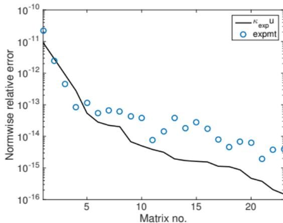
Relative error  $\|\text{expm}(T) - \text{expmt}(T)\|_2 / \|\text{expm}(T)\|_2$ .
